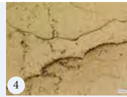
Abb. 3: DIC-Aufnahme der Ränder – Polierte Oberfläche direkt nach Applikation.
