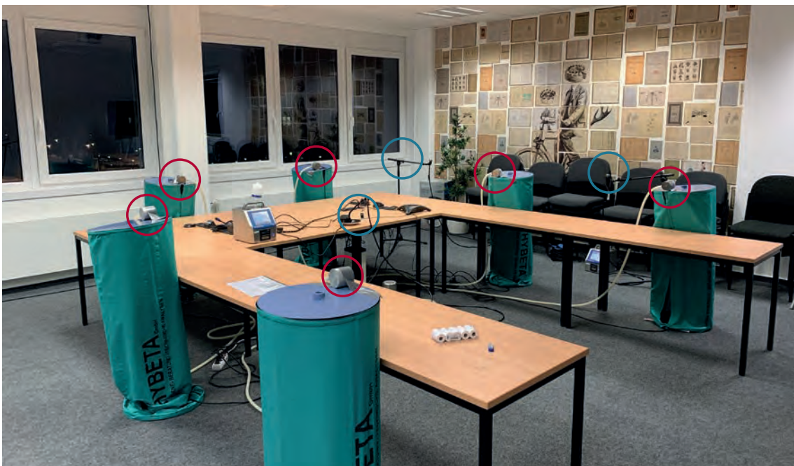
Abb. 1: Versuchsaufbau mit Dummies und Aerosolaufgabepunkten und Messpunkten
