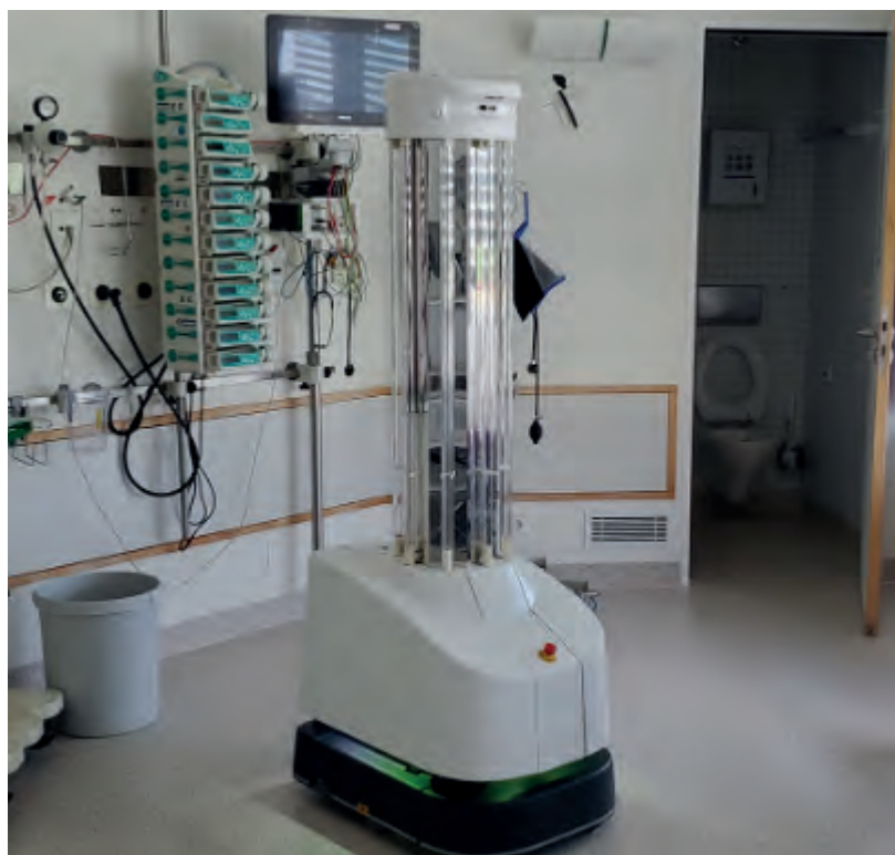
Abb. 1: UV-Desinfektionsroboter im Patientenzimmer. Quelle: Autoren
