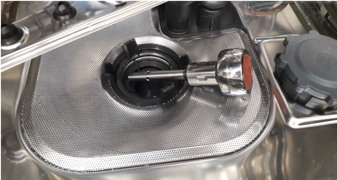
Abb. 2: Leitwertlogger im Ablauf der RDG zur permanenten Messung
