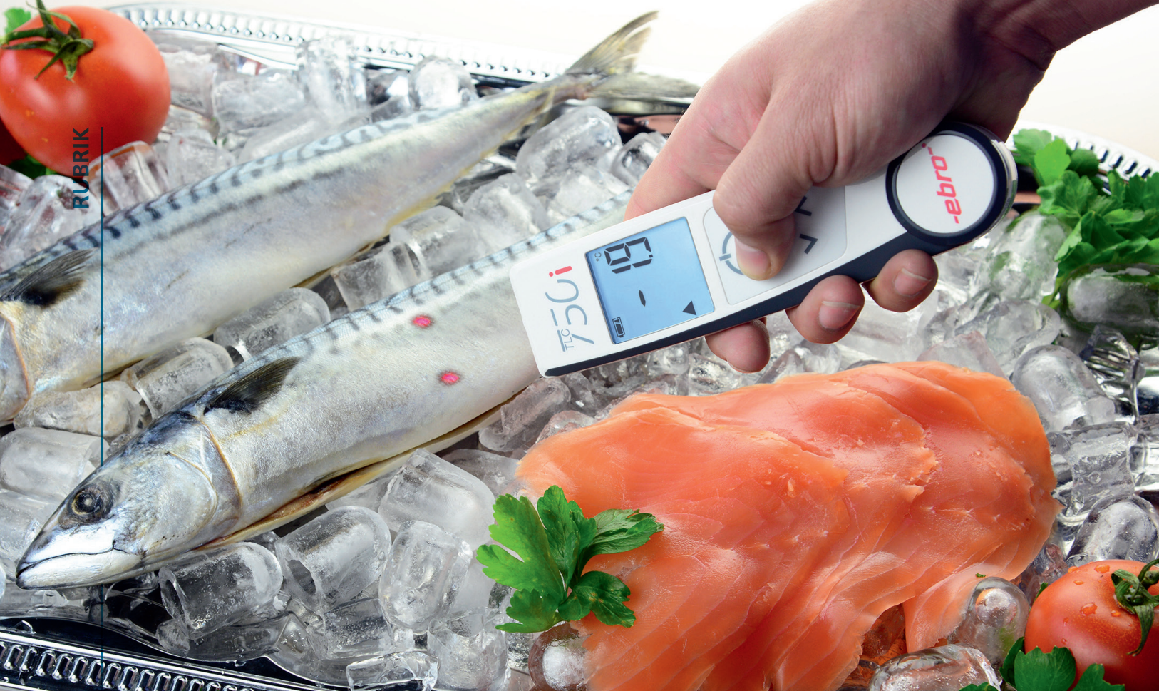
Oberflächentemperaturmessung (Foto: ebro)
