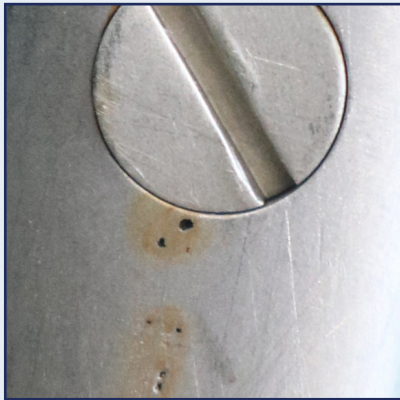
Abb. 3: Schere mit Lochkorrosion.
