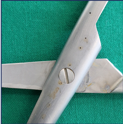
Abb. 1: Schere mit Lochkorrosion.
