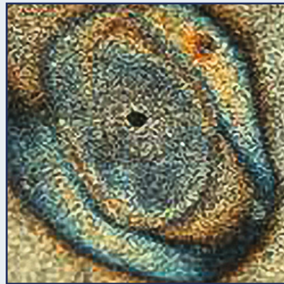
Abb. 4: Beispiel für Lochkorrosion.
