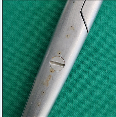
Abb. 2: Schere mit Lochkorrosion.
