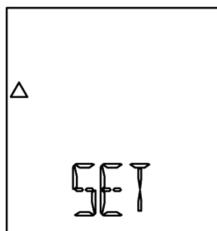
Im Display erscheint nun „SET“. Mit der »UP«-Taste erreichen Sie die Einstellmöglichkeiten für die Parameter der verschiedenen Öl- bzw. Fettarten.
