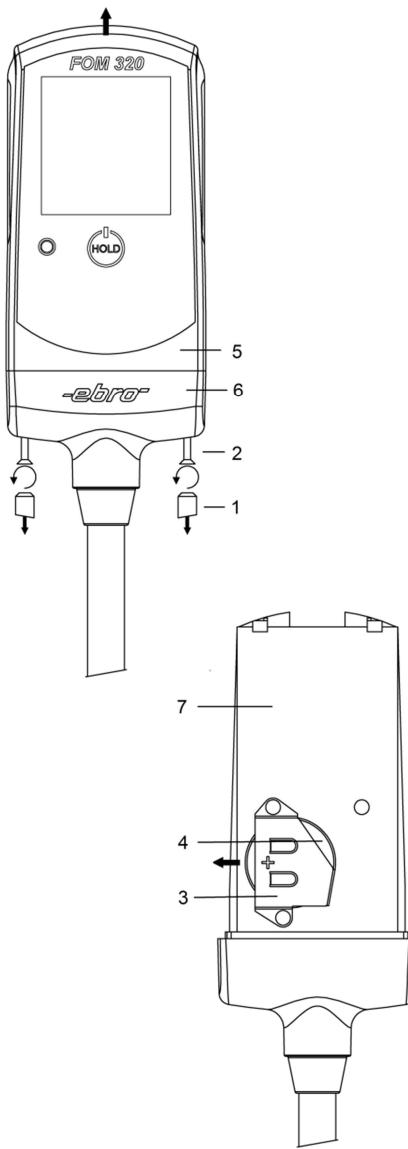
Das Batteriesymbol im Display zeigt Ihnen an, wann die Batterie gewechselt werden muss.
