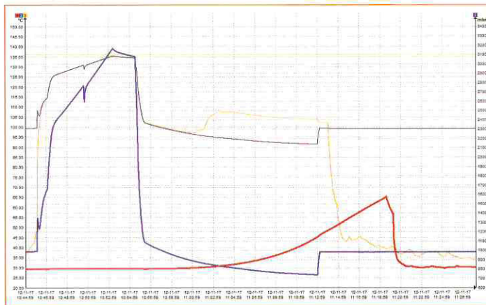
Abbildung 22 (Grafik): Beispiel eines fehlgeschlagenen Sterilisationsprozesses (keine aktive Luftentnahme). Aufzeichnung der Temperatur in der Kammer (orange Linie) und dem Mittelpunkt des Bowie-Dick-Paketes (rote Linie). Die blaue Linie zeigt den Druck in der Kammer. Die Temperatur im Mittelpunkt des Paketes nach der Sterilisation lag nur bei 30 °C.
