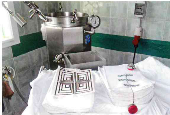
Abbildung 21: Monrovia, Liberia: Datenlogger für Druck/Temperatur erlauben die einfache Registrierung eines Sterilisationsprozesses, auch innerhalb der Ladung. Sehr nützlich für Vorführungen während einer Schulung.
