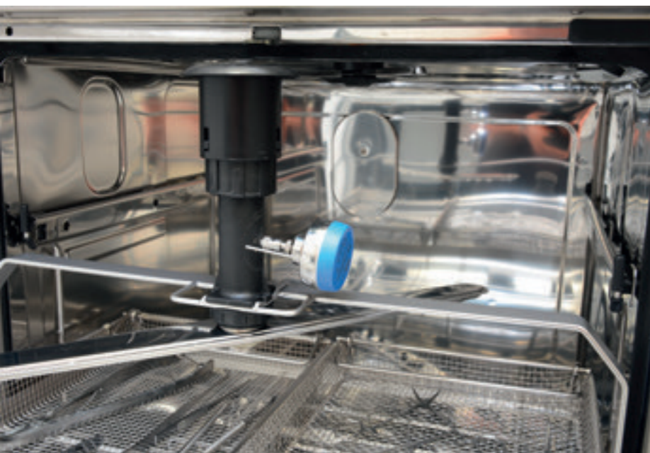
Bild 4: Beispiel einer Routinekontrolle mit EBI 100-TP231 im Miele G7882
